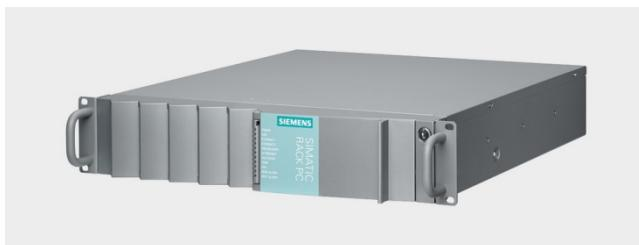
Мощный промышленный компьютер 19" исполнения с высотой корпуса 2 HU:
